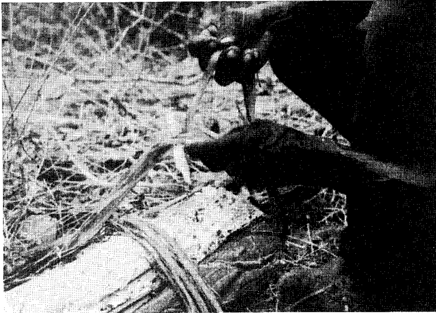
Figura 4. Las fibras retiradas de la "penca" son separadas en cintas, cuyo ancho determina la mena del cabo final.
