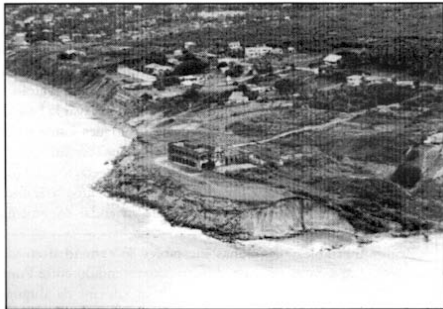
Figura 7. Zona crítica del Castillo ubicado al norte de Pradomar. Obsérvese en los acantilados activos las superficies de deslizamientos y los bloques localizados a 8 m de la costa que evidencian el retroceso acelerado de la misma.
