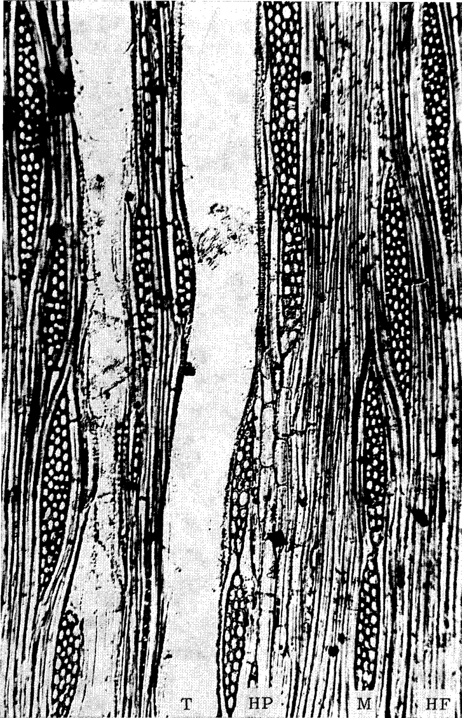
Abb. 4. Haematoxylon brasiletto . Tangentialer Längsschnitt durch das Sekundärholz. HF = Holzfasern, HP = Holzparenchym, M = Markstrahl, T = Trachee. 300/1 nat. Gr.
