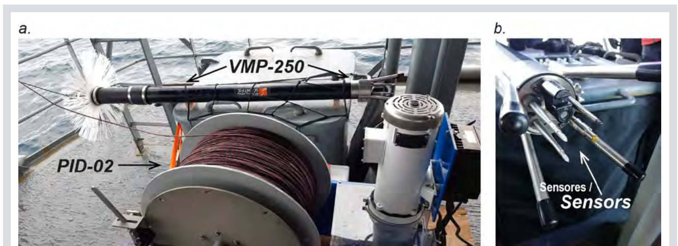
Figura 2. a. Equipo utilizado durante las estaciones oceanográficas, un VMP-250 y el cabrestante PID-02. b. primer plano de los sensores (temperatura, conductividad, cizallamiento, presión) utilizados durante la expedición.
