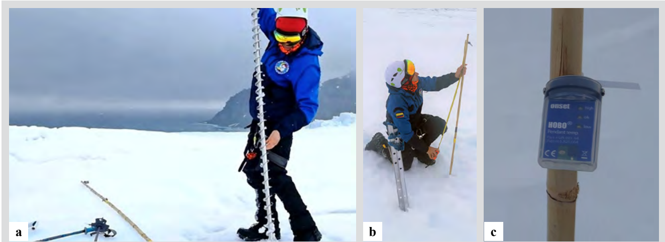
Figura 2. Metodología para instalar estacas de bambú en el Glaciar Lange (GL), IRJ, Antártica. a. Uso de un taladro Kovacs para la apertura de orificios sobre el glaciar y la instalación de estacas de bambú. b. Mediciones en la estaca para determinar el derretimiento de hielo en la zona de ablación. c. Sensor de temperatura instalado en la estaca. Fotos: a. - b. Jhon Mojica y c. Diego Mojica, 2019.
